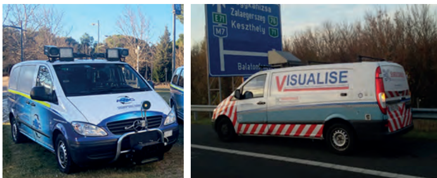
Figura 6. Equipos dinámicos AMAC y VISUALISE para la medida del coeficiente de retrorreflexión de la señalización vertical.
